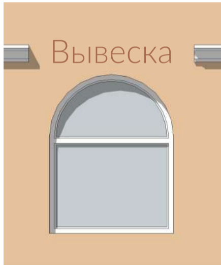
Знаки в цветовой гамме фасада здания
