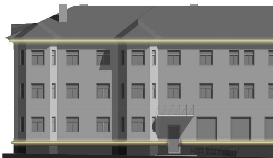
Контурная подсветка фасада здания
